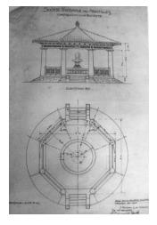
La buvette de la source Sainte-Anne des Abatilles a été dessinée par les architectes Protheau et de Miramont en mai 1925. Le plan est adapté à la fonction : choix d'un octogone permettant la déambulation autour de la fontaine. La structure verticale est composée de huit colonnes d'ordre toscan qui soutiennent la toiture. Les entrées sont pratiquées à l'est et à l'ouest et les espaces entre colonnes avaient été prévus ouverts, avec un parapet dans la partie basse uniquement.
